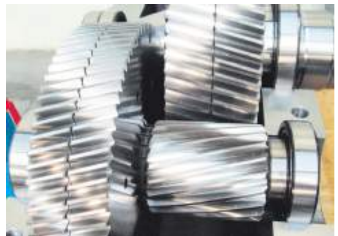
Hohlraumgesteuertes Getriebe / Backlash Controlled Gearbox
