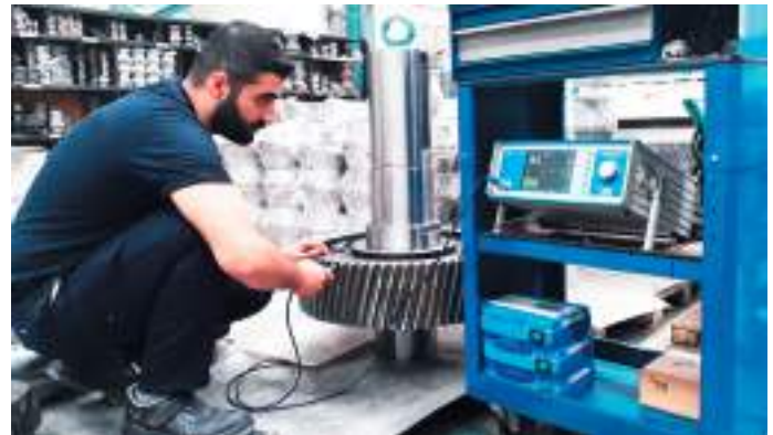
Ultraschallgerät zur Messung der Homogenität der Härtetiefe an der Zahnflanke Ultrasonically Hardness Depth Homogeneity Measurement Device on Tooth Flank
