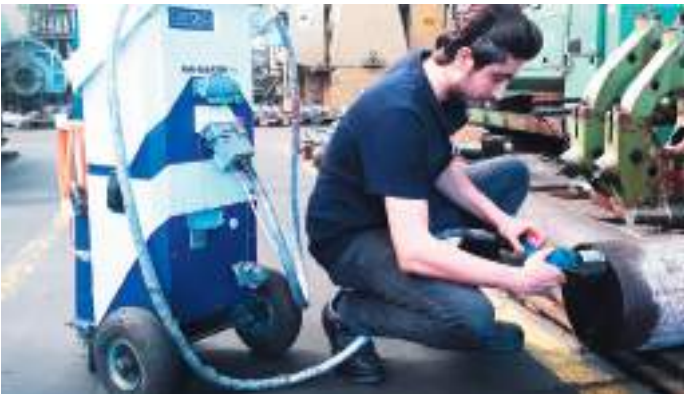
Spektralanalyse mit Kohlenstoffdetektion Spectral Analysis with Carbon Detection
