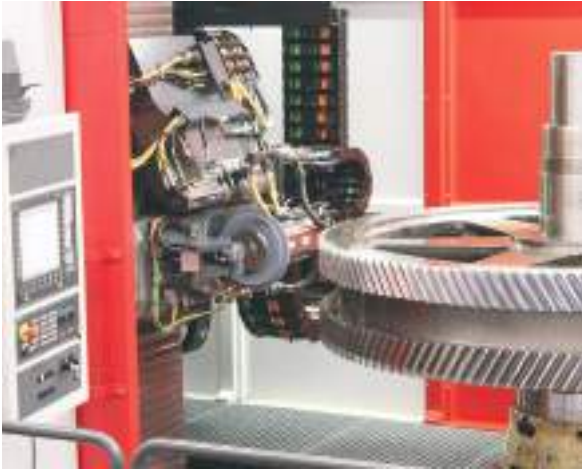
Außen-Schnecken Schleifen / External Helical Grinding
